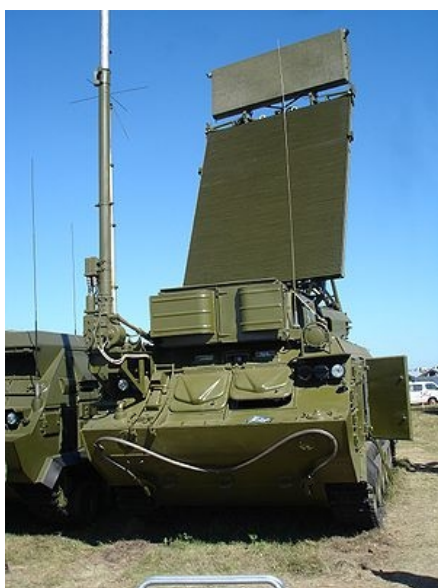
Photo 9. RLC 9C18M1 "Dome" Фото 9. РЛС 9C18M1 «Купол»
