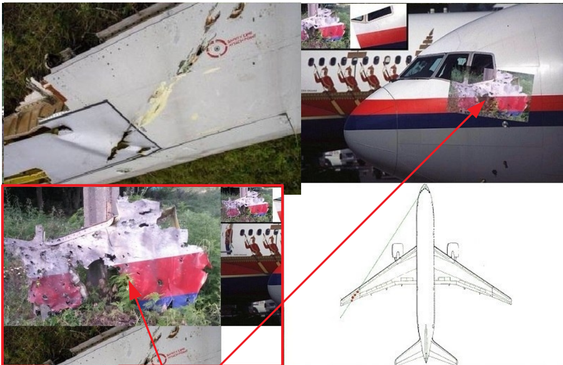
Photo 20. The nature of the damage to the cabin of the Boeing 777 Фото 20. Характер повреждений кабины Boeing 777
